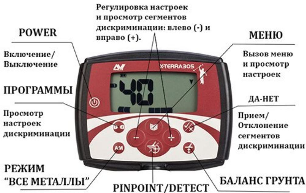
Две рабочие частоты 7,5 кГц и 17,75 кГц – универсальность металлоискателя. На высокой частоте можно осуществлять пляжный поиск монет драгоценностей, ювелирных украшений и прочей мелочевки, поиск предметов в траве, поскольку низкочастотная катушка хорошо цепляет именно мелочь на небольшой глубине. Низкая частота дает возможность прибору «видеть глубже» на треть, это удачный вариант для военного поиска, археологии.
